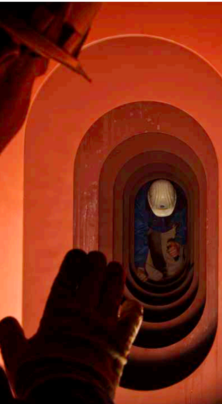
CONTROLEURS IN DE MOELIJK TOEGANKELIJKE BALLASTWATERTANKS VAN SCHEPEN - WERK DAT IN TOEKOMST DOOR ROBOTS WORDT GEDAAN
